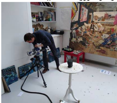
نموذج يوضح كيفية استخدام الماسح الضوئي ثلاثي الأبعاد في تحويل القطعة إلى صورة مجسمة على ذاكرة الحاسب
