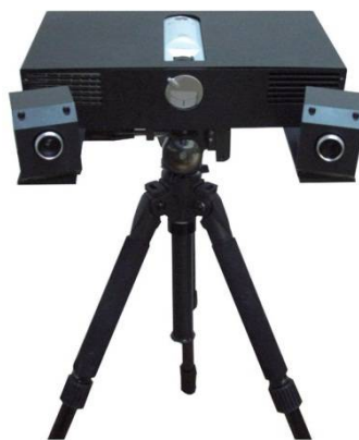
نموذج يوضح كيفية استخدام الماسح الضوئي ثلاثي الأبعاد في تحويل القطعة إلى صورة مجسمة على ذاكرة الحاسب
