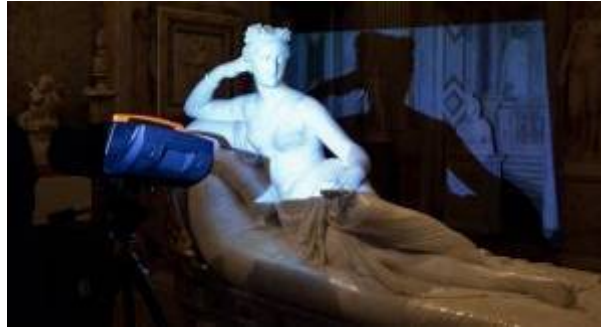
شكل (10) جهاز NUB 3D و عملية مسح ثلاثى الأبعاد لأحد التماثيل الرخامية (1)
